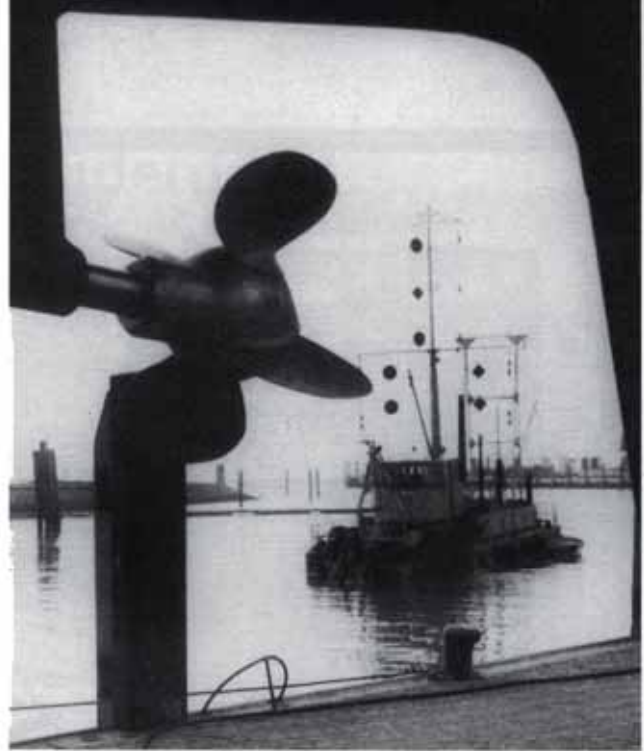
Alle zwei Jahre wird durchschnittlich jeweils die Hälfte des 109000 qm großen Norderneyer Hafenbeckens von dem landeseigenen Saug- und Spülbagger „Vampir“ bis auf eine Tiefe von NN (Normal Null) minus 4,50 m ausgebaggert, d.h., daß bei Normalniedrigwasser eine Hafentiefenwasser von 3,30 m gegeben ist. 1984 war die Ausbaggerung des vorderen Hafenbeckens für die Aufrechterhaltung des Schiffsverkehrs erforderlich. Es wurden etwa 35.000 cbm Schlack und etwa 25.000 cbm Sand ausgebaggert. Das Fährhafenbecken unmittelbar am Norderneyer Riffgat schlickt dagegen schneller auf. Hier muß die Unterhaltungsbaggerung durchweg einmal jährlich durchgeführt werden.
