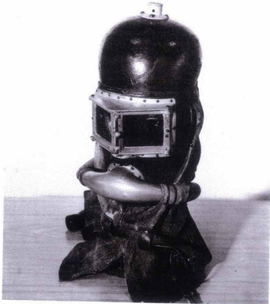
Saugschlauchmaske aus Pappmachee und Lederabschluß. Ausatemventil oben. Durch einen Schlauch mußte die Luft vom Träger angesaugt werden.
