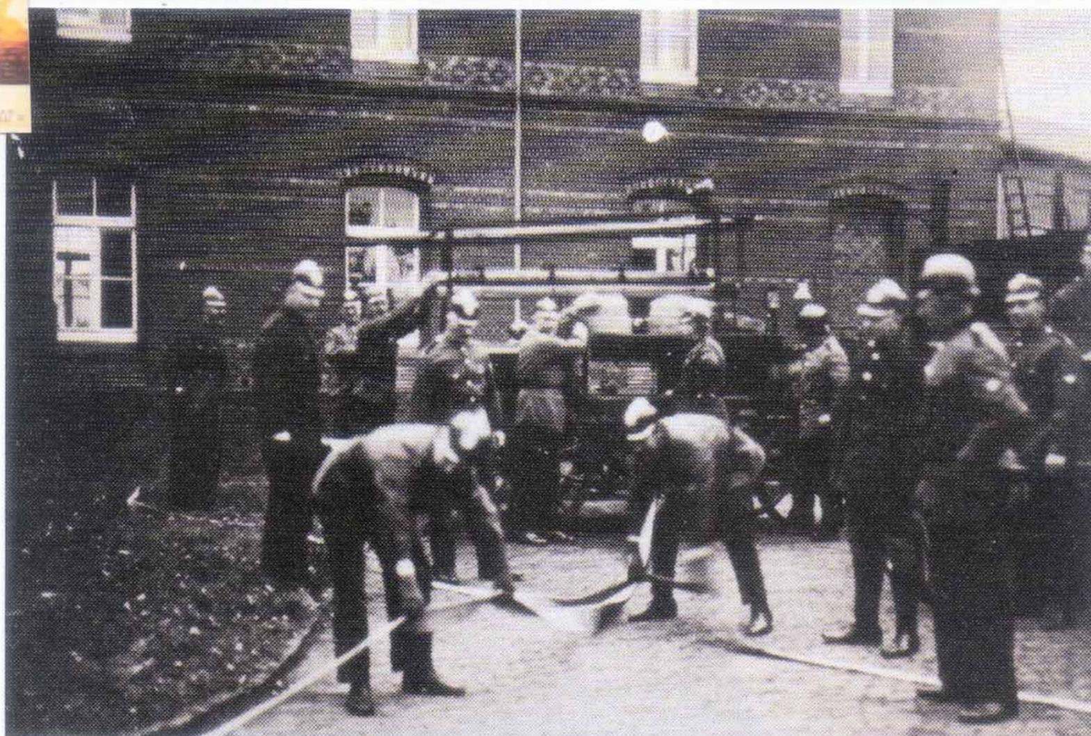
Übung mit der neuen 600 lt.Pumpe, handgezogen. Die Pumpe war in dem Wagen eingebaut. Dazu wurde der Boden tiefer gelegt.
