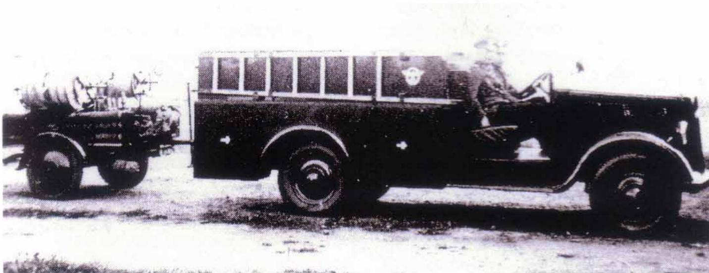
Kraftzugspritze KzS 8 mit Tragkraftspritzenanhänger, 1939.
