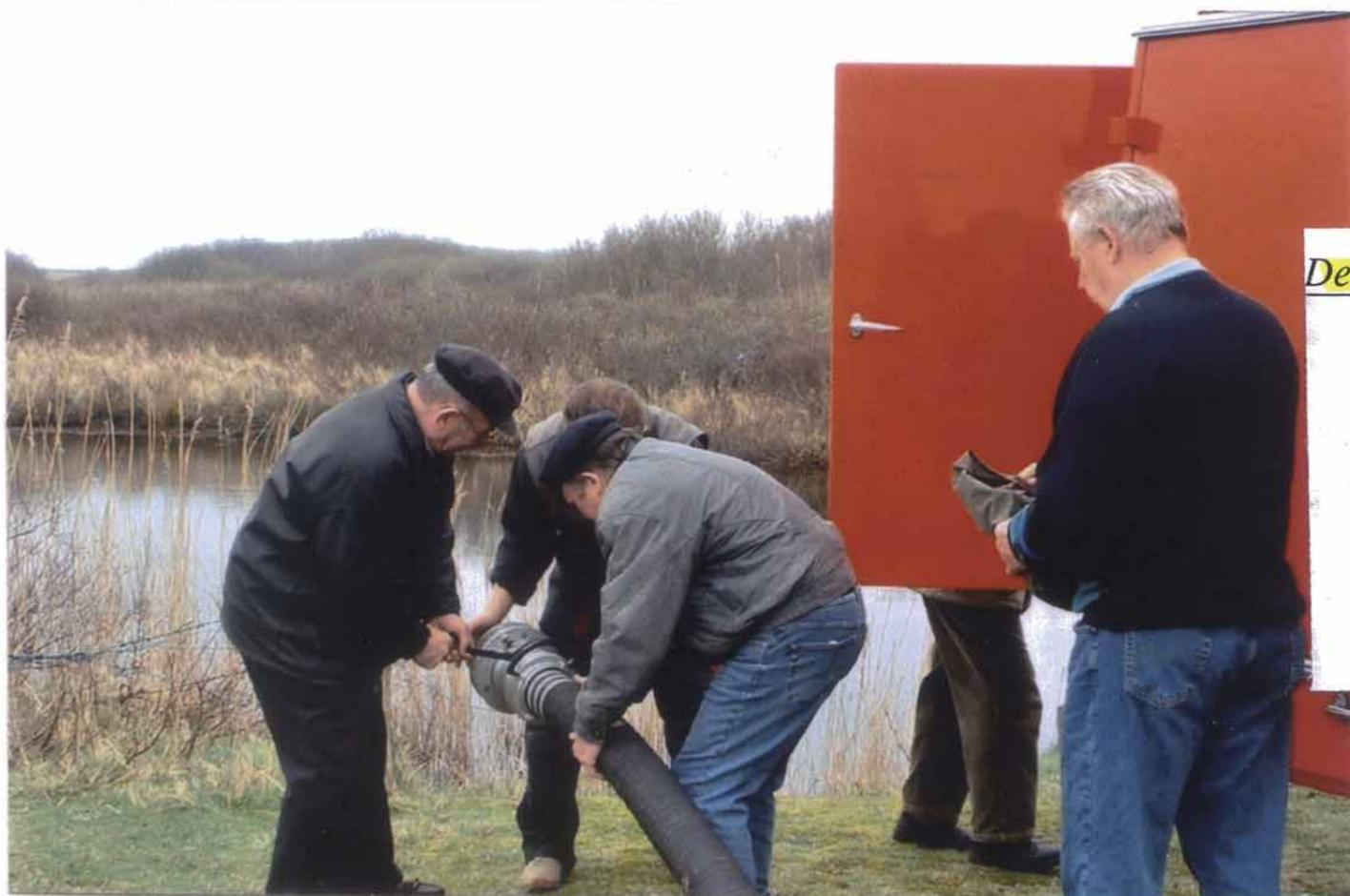
Der Saugkorb wird am Saugschlauch angekuppelt.
