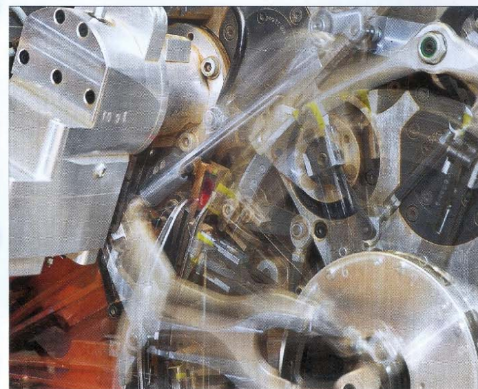
Das neuartige Nähaggregat befestigt Teebeutel und Etikett am Faden.
