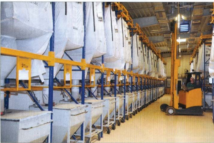
Automatisch erfolgt von hier aus die Teezufuhr über Vakuumleitungen zu den Teebeutelmaschinen.
