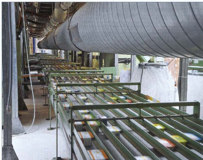
Das Fließband befördert die Teepackungen von der Maschine zur Sortierung und Endverpackung.
